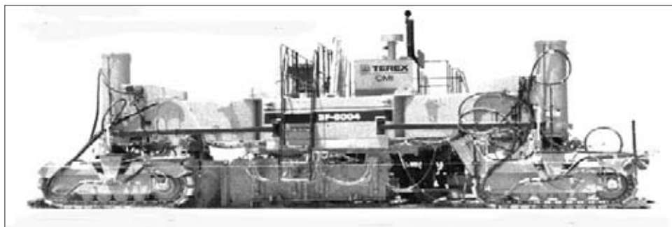
Foto 3. Pavimentadora de Hormigón.
