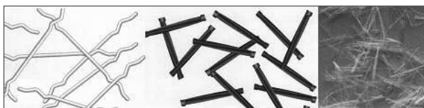
Figura 2. Las fibras utilizadas en el proyecto piloto de Roermond. De izquierda a derecha: fibras de acero largas y cortas, y fibras sintéticas.
