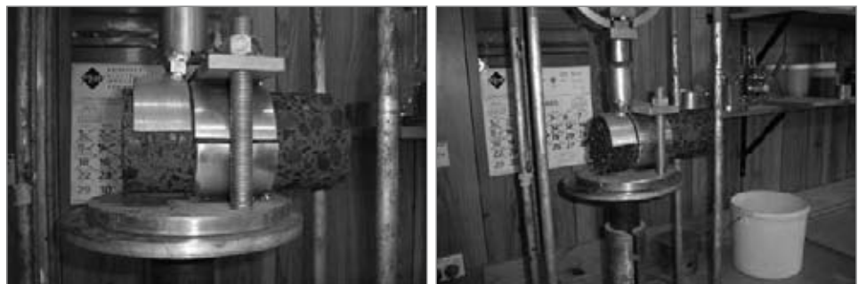
Foto 10. La adherencia entre capas se calculó aplicando una carga transversal a la interfaz de los testigos extraídos del firme de prueba.
