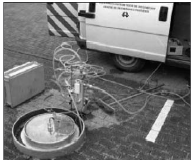
Foto 4. Infiltrómetro de doble anillo.
